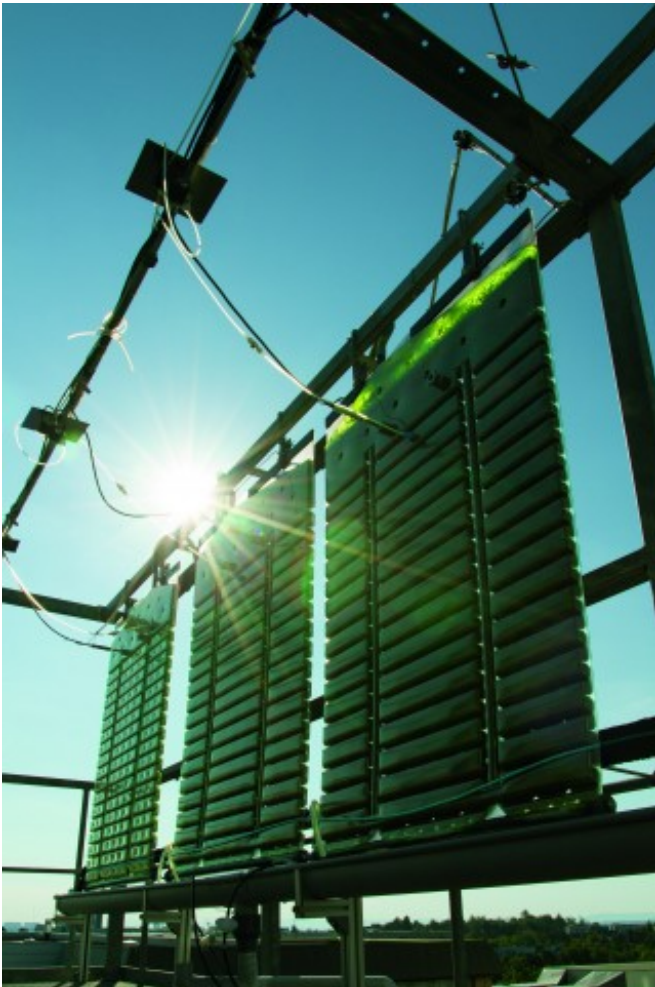
Der Flachplatten-Airlift-Photobioreaktor des Fraunhofer-Instituts für Grenzflächen- und Bioverfahrenstechnik IGB sorgt für eine gleichmäßige Lichtverteilung auf alle Algenzellen. © Fraunhofer IGB, Stuttgart
